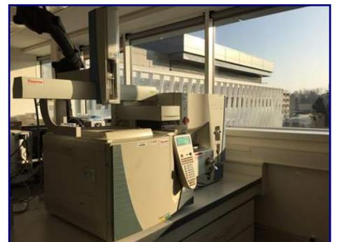
Système de chromatographie en phase gazeuse couplée à la spectrométrie de masse en tandem pour l'analyse des micropolluants organiques, LERES
