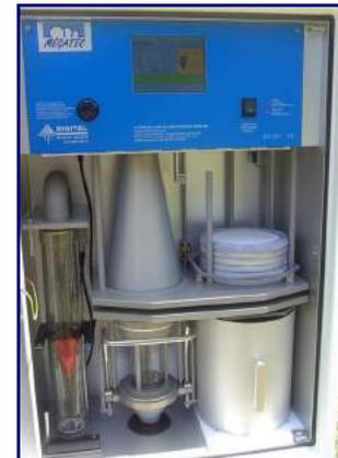
Capteur pour analyses chimiques, Gwad'Air
