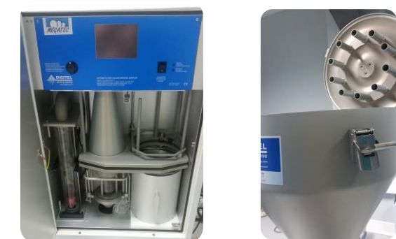
Figure 2 : intérieur du préleveur DA80 et sa tête de prélèvement
