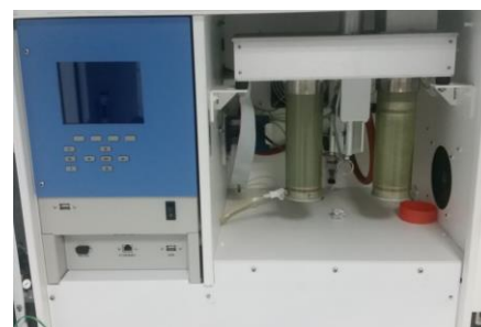
Figure 3 : intérieur du préleveur Partisol 2025.
