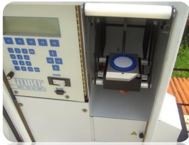
Figure 5 : intérieur du préleveur Partisol 2000
