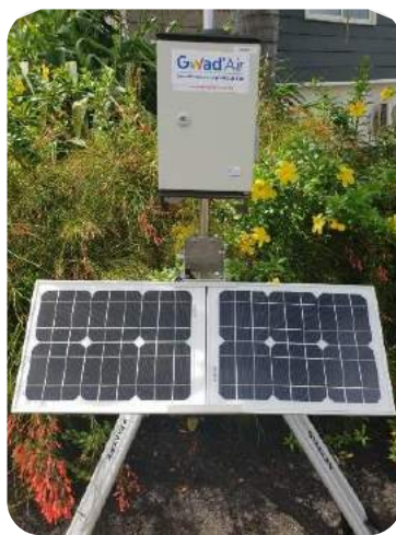
Figure 4 : Micro-capturage utilisé pour la mesure des concentrations en H_2S et NH_3
