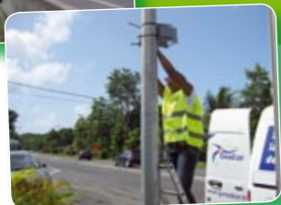
Pose des tubes de mesures des BTX
