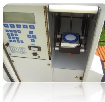
Figure 6 : intérieur du préleveur Partisol 2000
