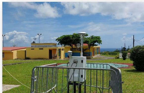
*Appareil de mesure DA80 positionné sur le site de Bélair*
